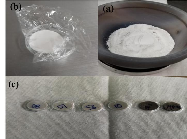
**Figura 4.** (a) Molida de la muestra del mineral (b) Pastillas prensadas para FRX junto (c) Pastillas para AAN con sus dos pastillas de MR (Material de referencia).
