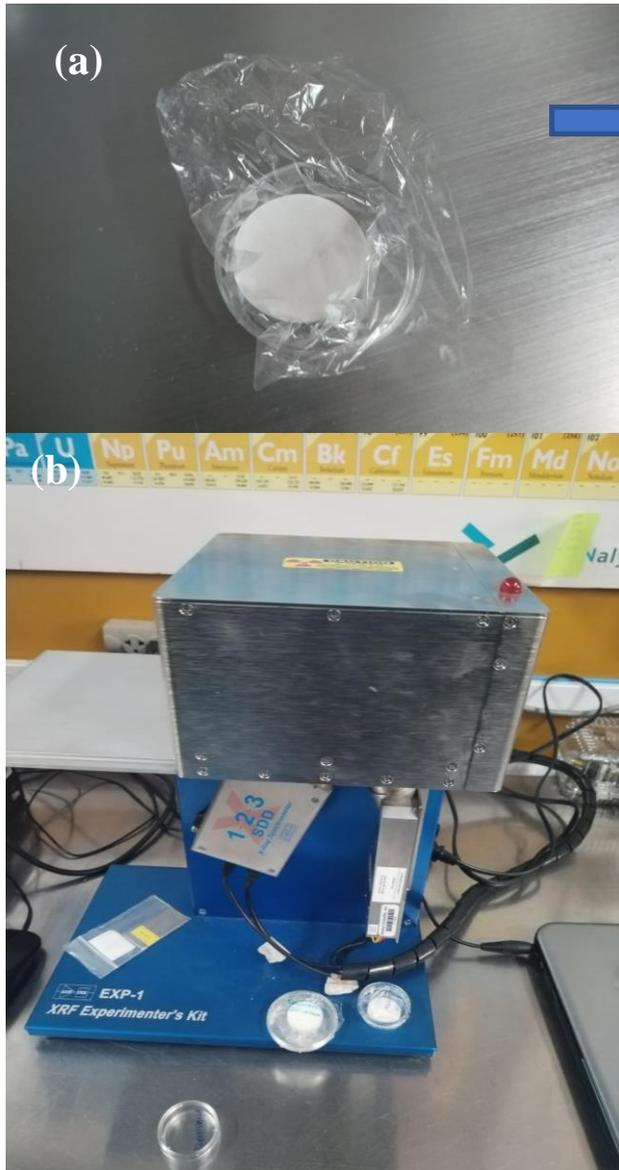
**Figura 7.** (a) Pellet del mineral y (b) Equipo de FRX.
