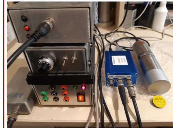
Amplificador Cremat CR-160/CR-200 reacondicionado por fallas en los opamps originales
