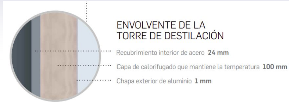
Detalles de revestimiento considerado
