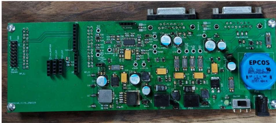
**La RedPitaya se conecta en la parte inferior izquierda para mejorar la disipación de calor**
